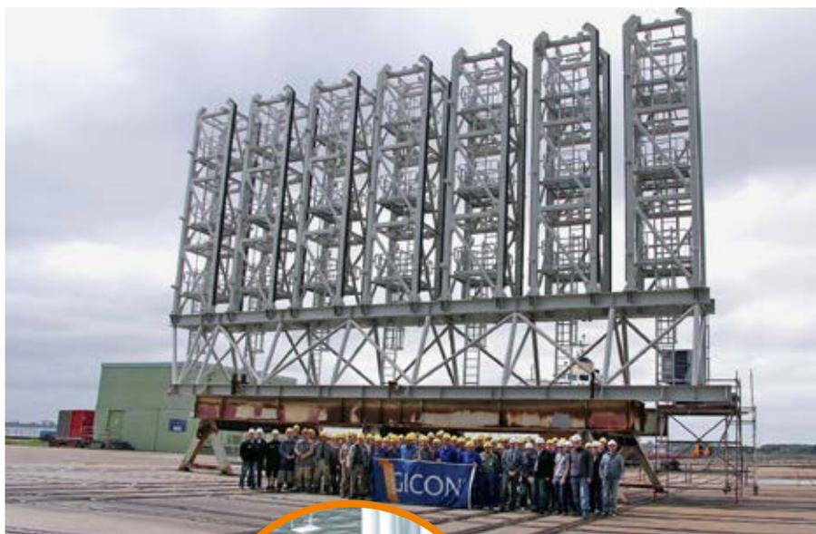
Nach nur zwei Monaten Fertigungszeit ist das von der ESG – Edelstahl und Umwelttechnik Stralsund GmbH konstruierte Blade Rack System verschifft und offiziell an den Auftraggeber EnBW Baltic 2 GmbH übergeben worden. Auf einem Errichterschiff installiert, lagert die Stahlbaukonstruktion zukünftig bis zu 18 Rotorblätter von Windkraftanlagen für den Offshore-Windpark EnBW Baltic 2 während des Transports in das Projektgebiet und der Installation auf See.
