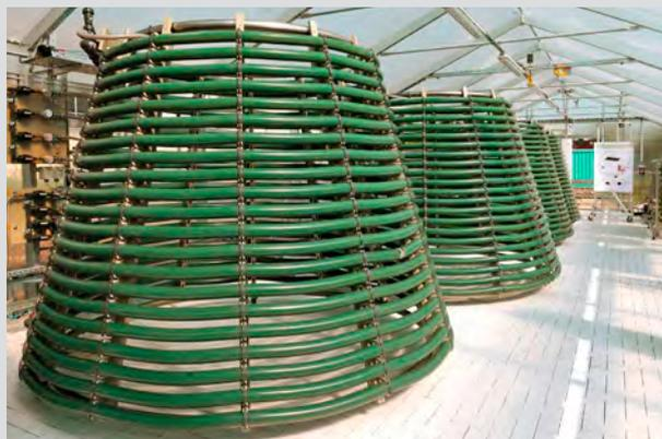
Photobioreaktor am Mitteldeutschen Biosolarzentrum Köthen
