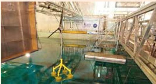
Deutschlands erste schwimmende Plattform für Windenergieanlagen – das GICON®-SOF – steht vor einem seiner wichtigsten Tests. Vom 17. – 28. September werden zwei Wochen lang im wissenschaftlichen Becken von SSPA die maßstäblichen Transport- und Installationsprozesse der TLP simuliert.
