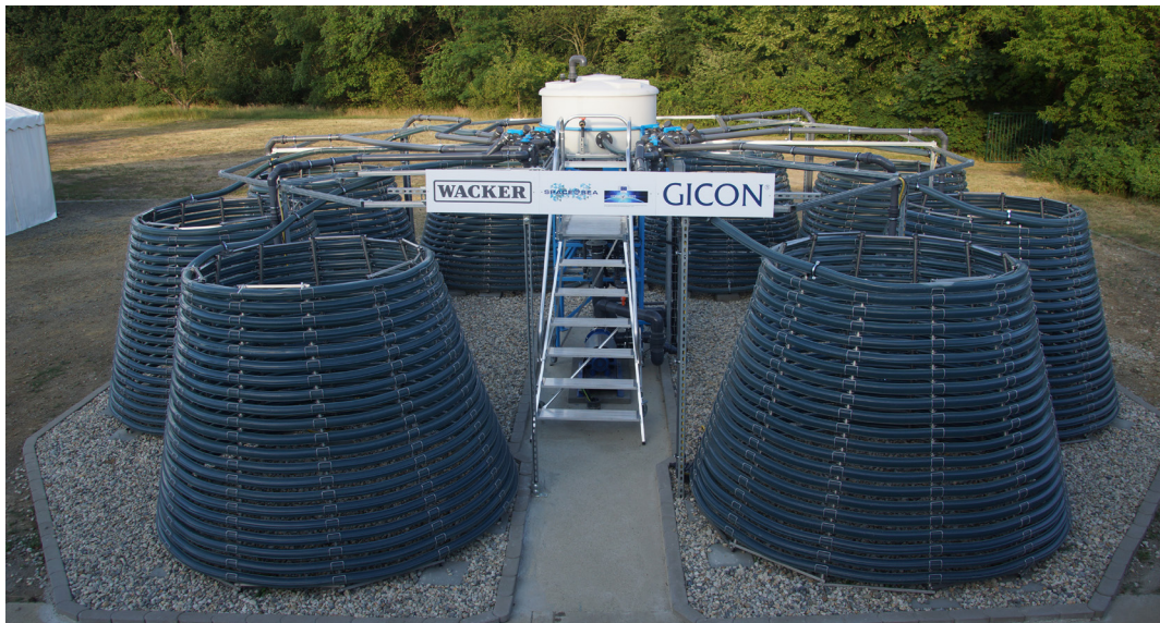
▲ Innovative Technologie in Cottbus. Das GICON® Oktagon. Acht miteinander verschaltete GICON®-PBR garantieren durch ihr innovatives Design und die Technologie die ganzjährige Mikroalgenproduktion.
