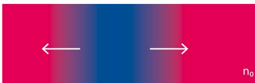
Vermischungsprozess bei einer gepulsten Infiltration **ohne Berücksichtigung des hydraulisch gering wirksamen Porenvolumens**; rot: kontaminiertes Grundwasser; blau: reaktiver Stoff;  $n_0$ : hydraulisch wirksame Porosität (auch als effektive Porosität bezeichnet); horizontale Pfeile: Wirkung der hydrodynamischen Dispersion; Grundwasserströmungsrichtung: von links nach rechts
