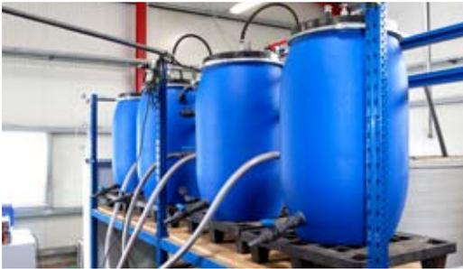
Das Versuchstechnikum verfügt über verschiedene Reaktoren und Versuchsanlagen zur Behandlung und Untersuchung verschiedenster Stoffströme. Im Bereich Biogastechnologie liegt der Schwerpunkt dabei auf der anaeroben Behandlung nachwachsender Rohstoffe sowie von organischen Rest- und Abfallstoffen. Neben der Ermittlung des möglichen Biogaspotenzials der eingesetzten Substrate kön-
