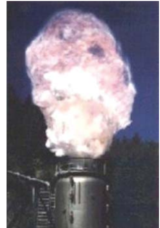
Staubexplosion in einem 60 m 3 -Behälter auf dem Versuchsfeld der BGN/FSA (Quelle: Technisches Hilfswerk)
