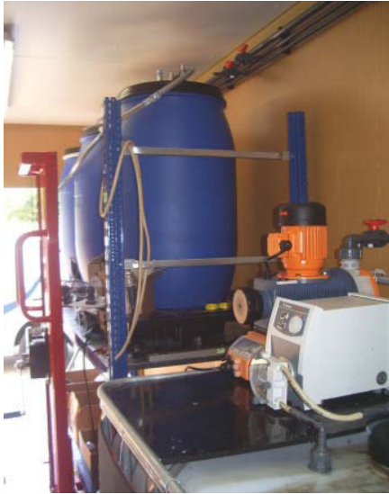
▲ Blick in den Versuchscontainer mit Methanreaktor während der Montage
