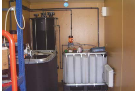
▲ Blick in den Versuchscontainer mit Methanreaktor während der Montage
